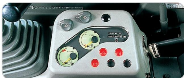
L'allarme controlla la pressione dell'olio motore, la carica della batteria e la temperatura del liquido di raffreddamento. I problemi potenziali sono così identificati in anticipo.
