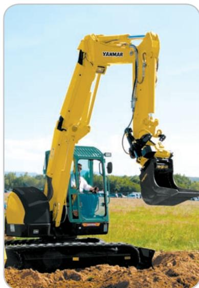
Braccio costruito in acciaio speciale leggero ad elevata resistenza elastica (1,5 volte superiore all'acciaio tradizionale) : la riduzione del peso morto rende la macchina più stabile e aumenta la capacità di sollevamento.
