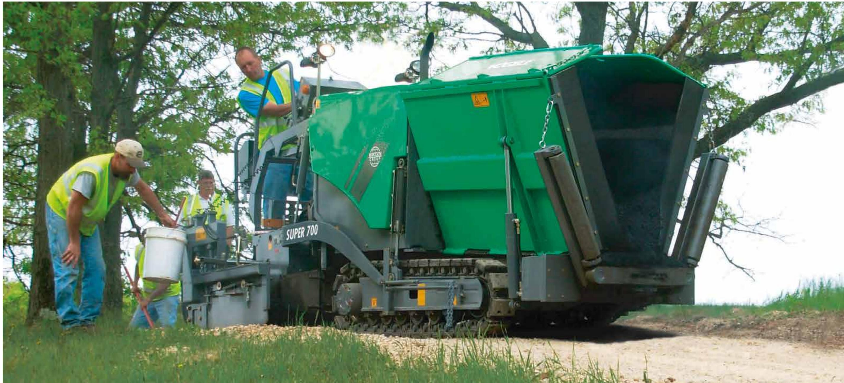
La finitrice SUPER 700 è stata studiata per consentire un'ampia gamma di utilizzi nei più svariati cantieri. La finitrice è predestinata a interventi di piccola e media entità, come il riempimento di trincee di canalizzazione o la realizzazione di piste ciclopedonali, ma anche all'asfaltatura di superfici trafficabili e strade minori. Tra i particolari punti di forza della finitrice vanno
