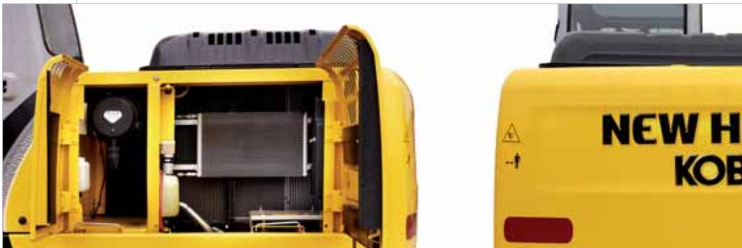
La semplice disposizione di tutti i componenti vitali del nuovo escavatore New Holland E175B, posizionati dietro i pannelli di destra e di sinistra, riduce i tempi e i costi della manutenzione e assicura un'assistibilità molto migliore. Tutti i compartimenti sono estremamente spaziosi e la maggior parte dei componenti sono posizionati in modo tale da garantire una facile accessibilità da terra. **Estetica moderna ed elegante coniugata con una tecnologia d'avanguardia.**
