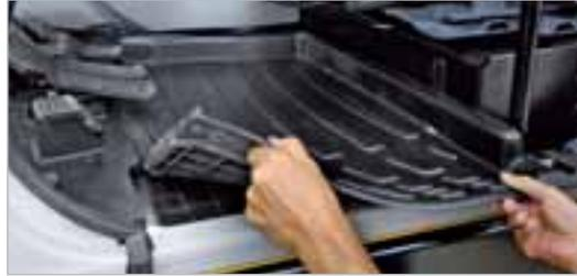
■ Tappetino in due pezzi staccabile, con impugnature per una comoda rimozione. Uno scarico a pavimento, posizionato sotto il tappetino, facilita la pulizia dell'abitacolo.
