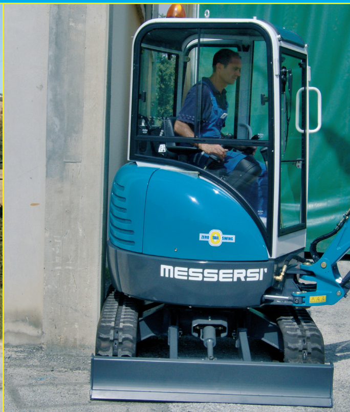
Dettaglio rotazione in sagoma della macchina (zero tail swing) / Détail de la rotation de la machine sans dépassement des chenilles (zero tail swing) / Detalle rotación con Cero Giro de Cola de la máquina (zero tail swing)
