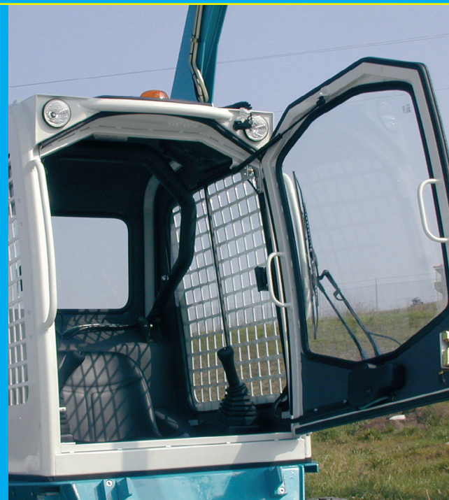
Cabina con porta anteriore (optional), ROPS/FOPS 1° e 2° / Cabine avec porte antérieure (optionnelle), ROPS/FOPS 1° et 2° / Cabina con puerta delantera (opcional), ROPS/FOPS 1° y 2°
