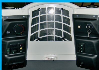
Posto guida con joystick, barra di sicurezza e cruscotto / Poste de conduite avec joystick et barre de sécurité / Asiento con joy-stick, barra de seguridad y salpicadero
