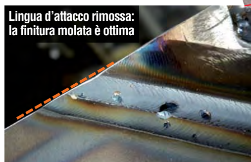
Lingua di attacco saldatura per avere qualità omogenea nel cordone
