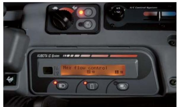
Il sistema unico di controllo intelligente Kubota (KICS) vi dà il controllo preciso del flusso di olio in base alle vostre esigenze o in funzione dell'accessorio in uso.
