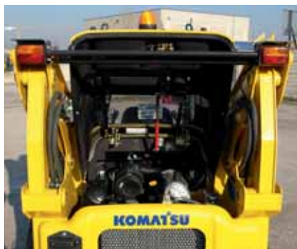
Il cofano: rapido controllo del motore
