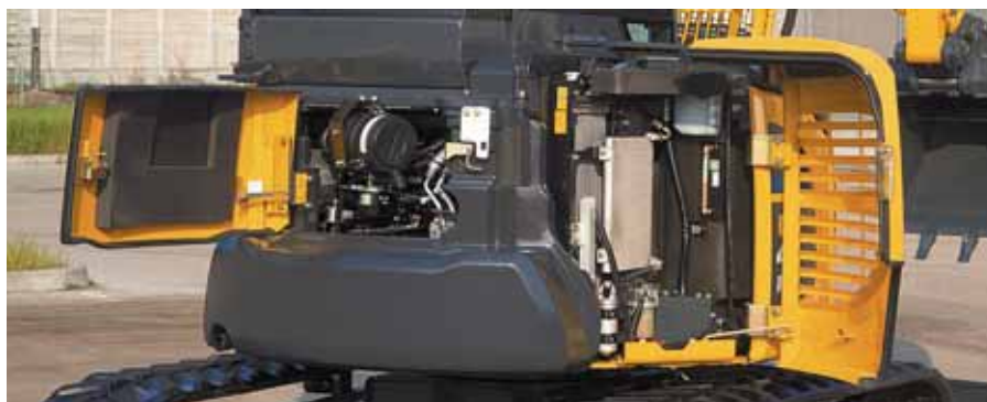
Cofani posteriori per controllo del motore, rifornimento carburante, ispezione e pulizia dei radiatori ed accesso alla batteria
