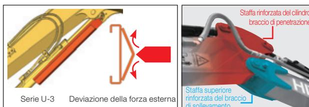
La protezione del cilindro braccio di sollevamento è angolata per aumentare la resistenza, e sono state rinforzate anche la staffa del cilindro braccio di penetrazione e la staffa superiore del braccio di sollevamento.
