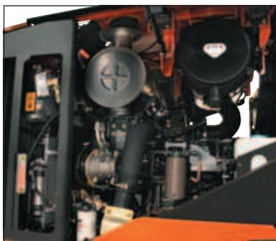
Il filtro e il prefiltro carburante con funzione di sedimentazione e il filtro dell'olio motore sono in posizione strategica, per agevolare l'ispezione giornaliera e facilitare la manutenzione al suolo.
