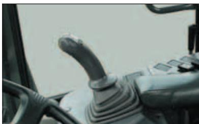
La leva joystick multifunzione è posizionata in cima alla leva di controllo per agevolare le manovre.
