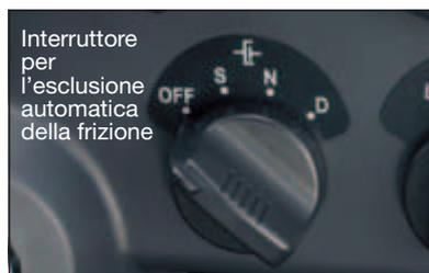
**Modo S:** la frizione viene esclusa in tempi rapidi premendo il pedale per il carico veloce su terreno livellato.
