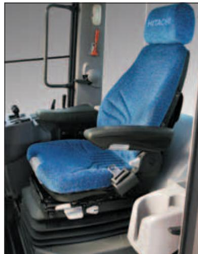
Il sedile a sospensione pneumatica consente molteplici regolazioni: peso-altezza, posizione avanzata-arretrata e angolazione dei braccioli, lunghezza e angolazione del cuscino del sedile, altezza e angolazione del poggiatesta e supporto lombare. Il riscaldatore del sedile è montato di serie.
