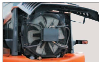
La velocità della ventola può essere regolata in base alla temperatura del fluido, per raffreddare efficacemente refrigerante, olio idraulico, olio della trasmissione e olio del convertitore di coppia. Il risultato è una maggiore durata di servizio dei componenti e un minore consumo di carburante. Per agevolare la manutenzione, la ventola è separata dal motore.
