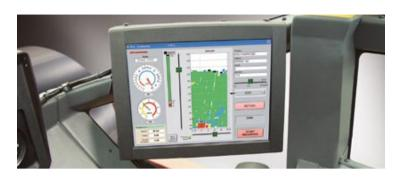
L'analizzatore di compattazione per asfalto Dynapac DCA-A (Dynapac Compaction Analyzer for Asphalt) è lo strumento perfetto per gli operatori. Fornisce informazioni in tempo reale sulla rullatura, consentendo di programmare il passo successivo, prendendo in considerazione la temperatura dell'asfalto di ogni area.
