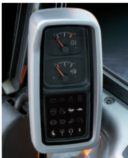
Pannello di strumentazione di tipo fisso
