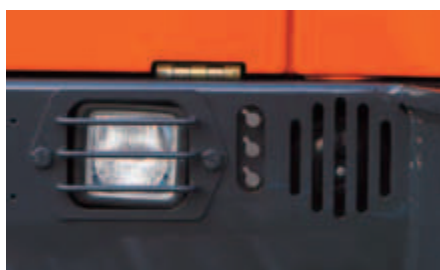
Condotti di lubrificazione
