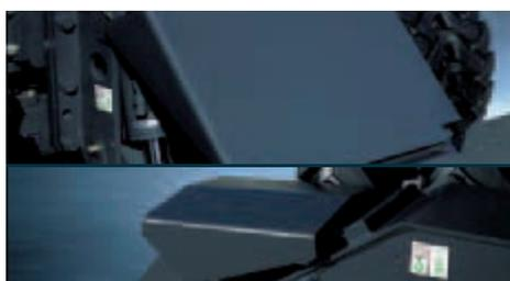
**Coperchi di protezione dei cilindri della lama e degli stabilizzatori**
