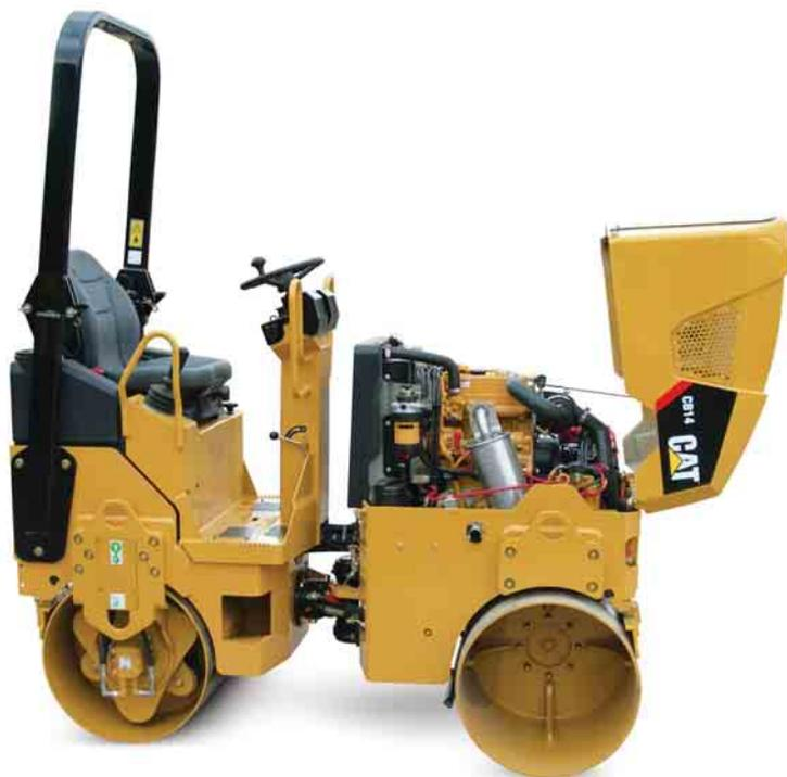
**Cofano motore.** Il cofano motore in vetroresina si apre verso l'alto e si blocca in posizione aperta tramite un'asta dedicata.
