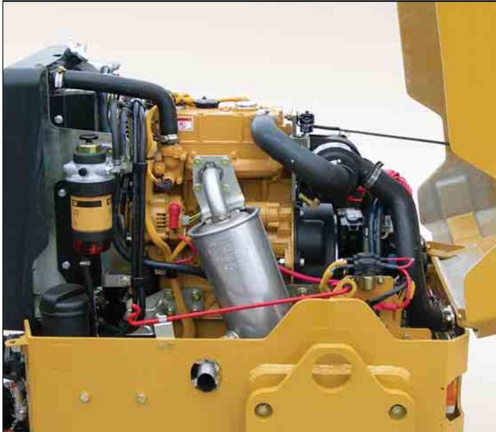
**Potenza.** Il motore Caterpillar C1.1, raffreddato a liquido, fornisce una potenza lorda di 16,1 kW (22 hp) a 2400 giri/min ed assicura eccellenti prestazioni, con ridotti livelli di rumorosità, per il massimo comfort operatore.
