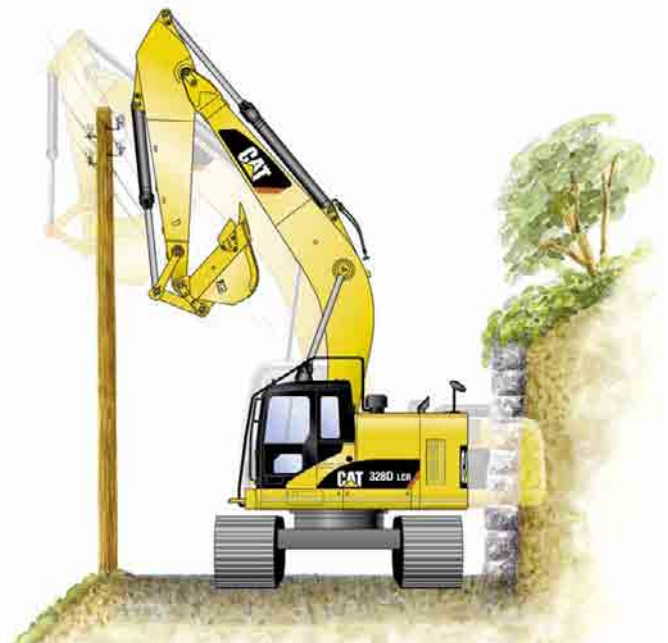
328D LCR vs 325D L. Raggi d'ingombro anteriore e posteriore
