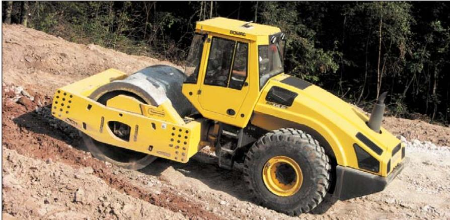
I rulli vibranti monotamburo con tamburo poligonale conquistano il settore delle opere in terra.
